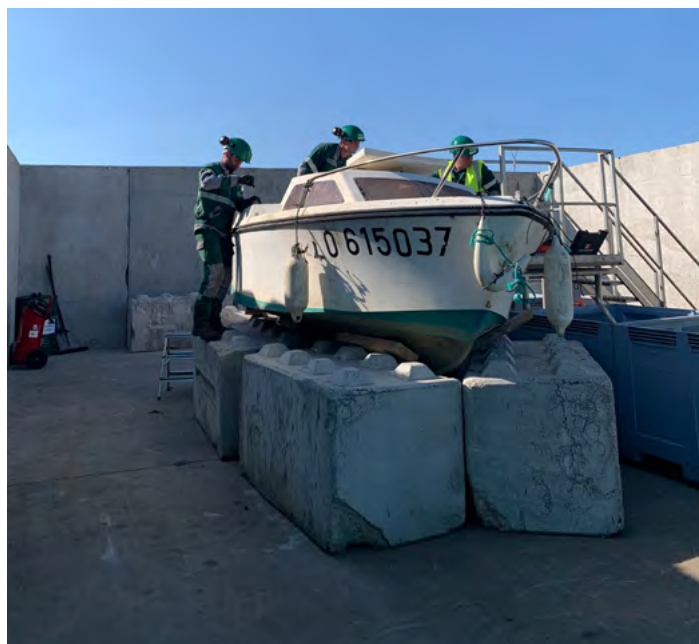
Un bateau à moteur en phase de dépollution dans un centre de traitement agréé par l'APER, juste avant sa déconstruction. © Guillaume Raillard - Agence Kern
